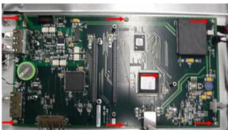
Рис. D-37. Крепежные винты материнской платы.
