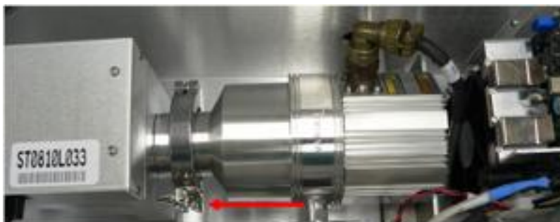
Рис. D-4 Хомутовое соединение NW25 спектрометра
