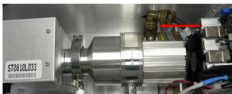
Рис. D-5 Хомутовое соединение NW25 спектрометра
