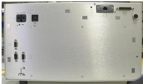
Рис. 1-6. Задняя панель базового блока VS C-15.
